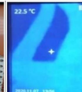
Termografia após a substituição do disjuntor.
